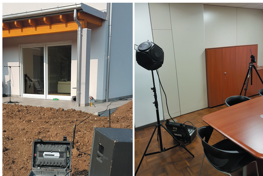
Fig. 1 - Misura in opera dell'isolamento acustico normalizzato di facciata (sx), e dell'isolamento acustico normalizzato di una partizione D_{nT,w} (dx).
